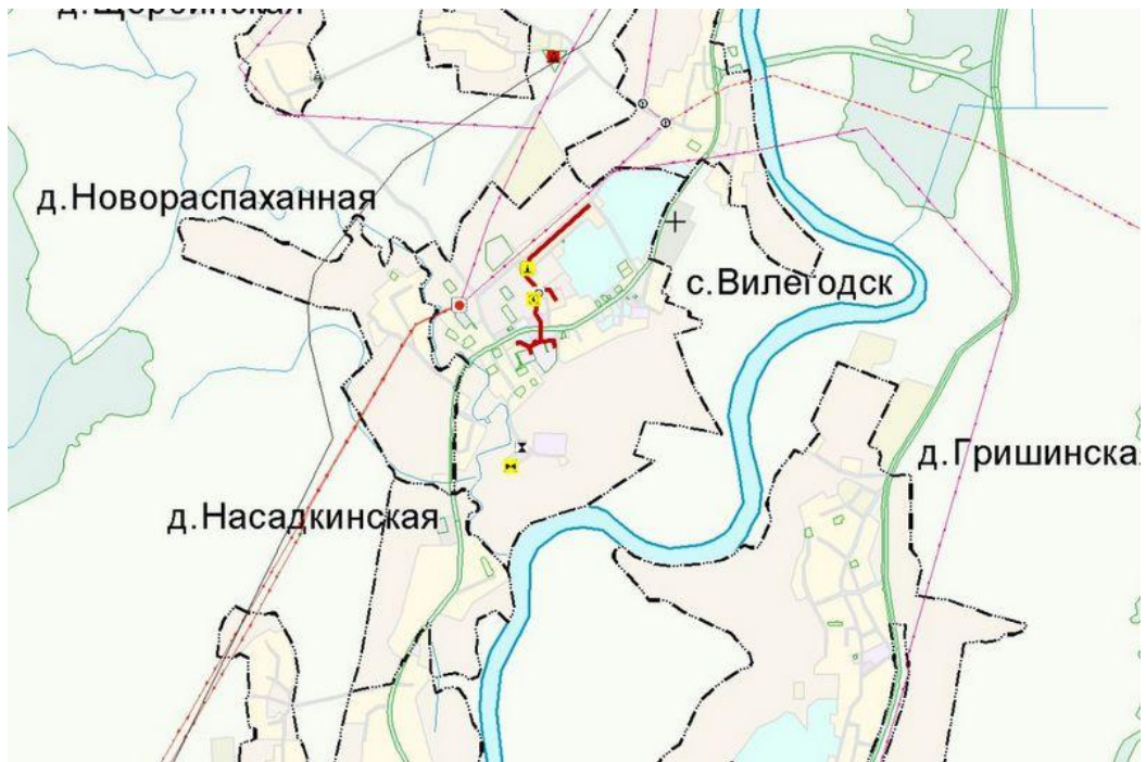
Рис. 1.7. Зоны действия источников тепловой энергии в с. Виле́годск
